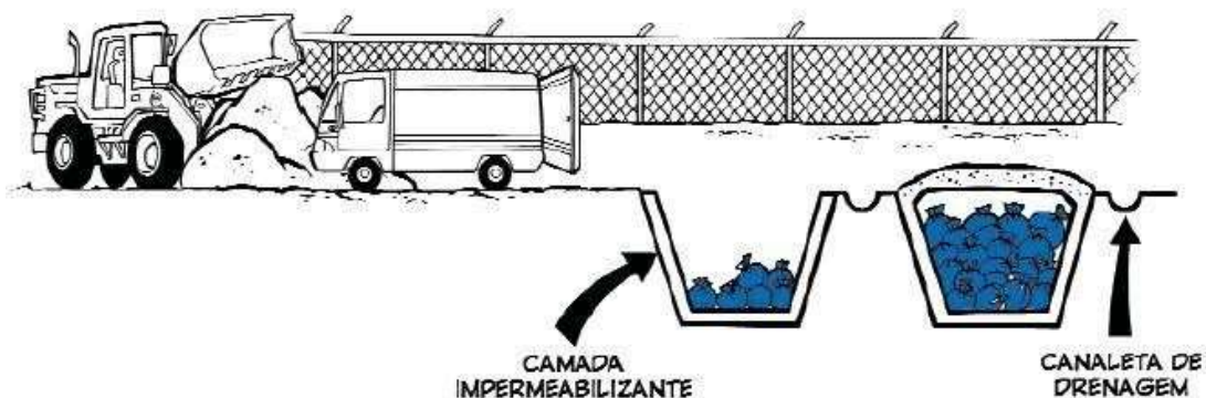
Figura - Características de uma vala séptica
