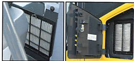
Filtro interno do ar condicionado
