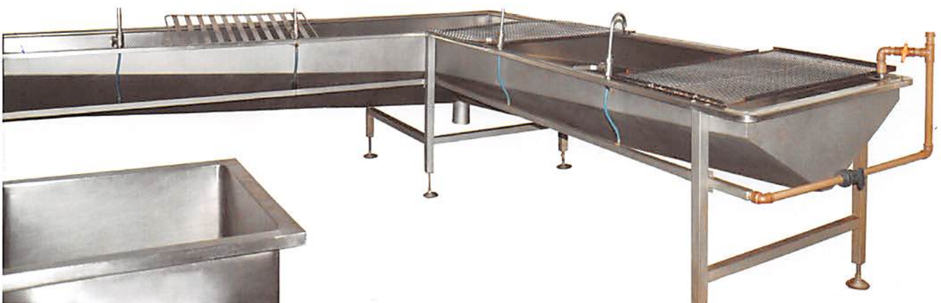
Calha de Sangria e Tanque de Escalda
