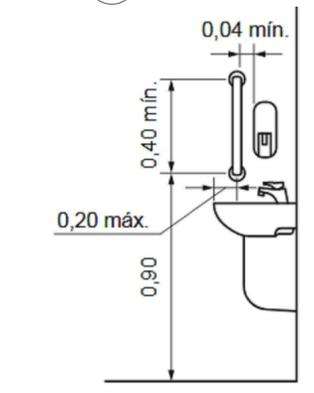
Detalhe 05 - barras de apoio Lavatório
