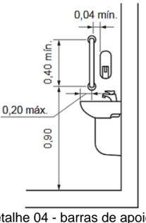
Detalhe 04 - barras de apoio Lavatório
