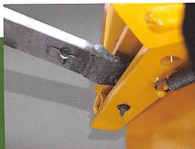
Encaixe com pino na base do trator
