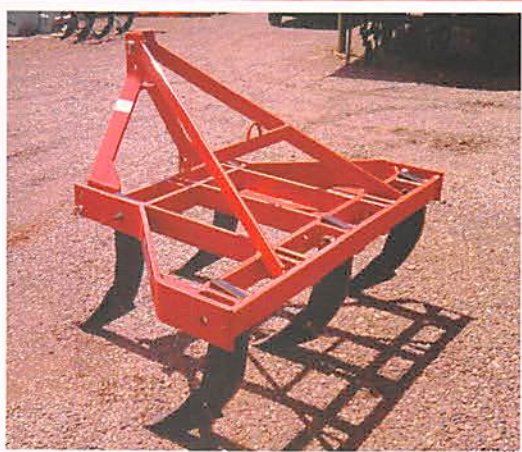
Arado Subsolador com Pino - Arado Subsolador com Pasador
