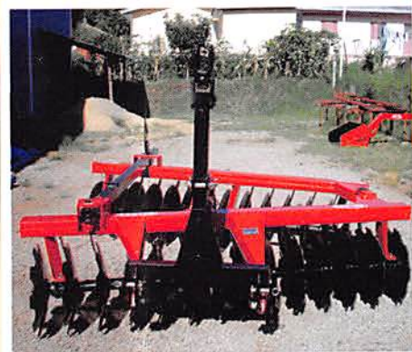
Grade niveladora hidráulica
