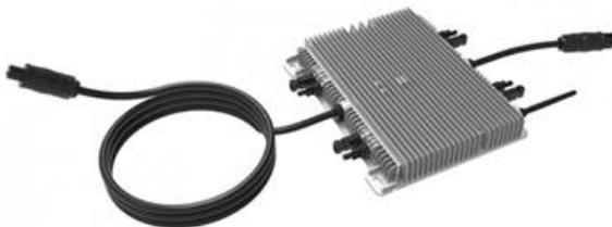
A central contempla a instalação de 04 (quatro) Microinversores bifásicos. Suas funções na instalação é a de assegurar a conversão da energia CC, proveniente dos módulos fotovoltaicos, em energia CA. Esta energia é entregue em baixa tensão no QGBT localizado no interior da edificação, nos valores padronizados pela concessionária, de 220 V, à frequência de 60Hz.
