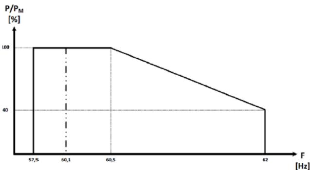
O Microinversor deverá atender às disposições anti-ilhamento respeitando as disposições das normas técnicas aplicáveis. Em caso de falha de fornecimento de energia da parte da rede de distribuição, a desconexão automática dos inversores terá de ocorrer, no máximo em 2s.
