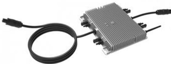
A central contempla a instalação de 02 (dois) Microinversores bifásicos. Suas funções na instalação é a de assegurar a conversão da energia CC, proveniente dos módulos fotovoltaicos, em energia CA. Esta energia é entregue em baixa tensão no QGBT localizado no interior da edificação, nos valores padronizados pela concessionária, de 220 V, à frequência de 60Hz.
