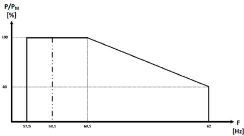
O Inversor deverá atender às disposições anti-ilhamento respeitando as disposições das normas técnicas aplicáveis. Em caso de falha de fornecimento de energia da parte da rede de distribuição, a desconexão automática dos inversores terá de ocorrer, no máximo em 2s.
